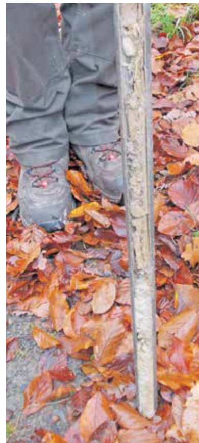
Der Bohrstock wird in den Boden gedreht, um anhand der entnommenen „Erd-Säule“ die Tiefe und Dicke der Erdschichten des Waldbodens, z.B. einer Wiederaufforstungsfläche, beurteilen zu können
